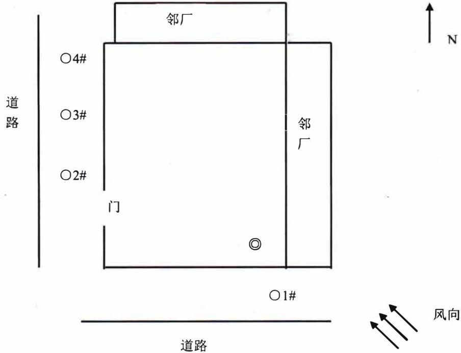
注：“◎”有组织废气监测点位；“○”无组织废气监测点位。
